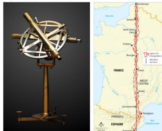
Cercle répétiteur de Borda, Musée des arts et métiers (à gauche) Triangulation de Dunkerque à Barcelone (à droite)
